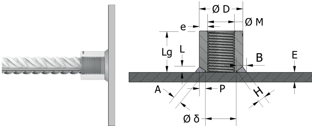
Lorsque vous avez besoin de souder des armatures à un élément métallique, le coupleur SD sert de liaison entre cette structure métallique et le béton armé.
